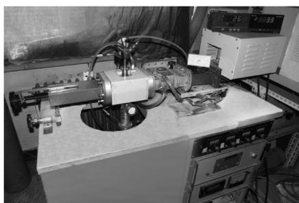
图4 阶梯喷嘴结构的常压微波等离子体装置实物图
