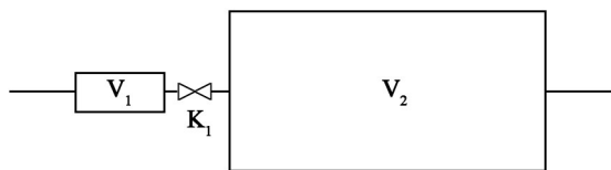
图2 静态膨胀法标准系统原理图
