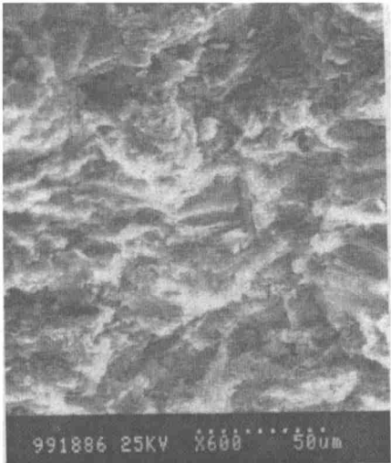
图 4 真空等离子喷涂 SEM 断面形貌图
