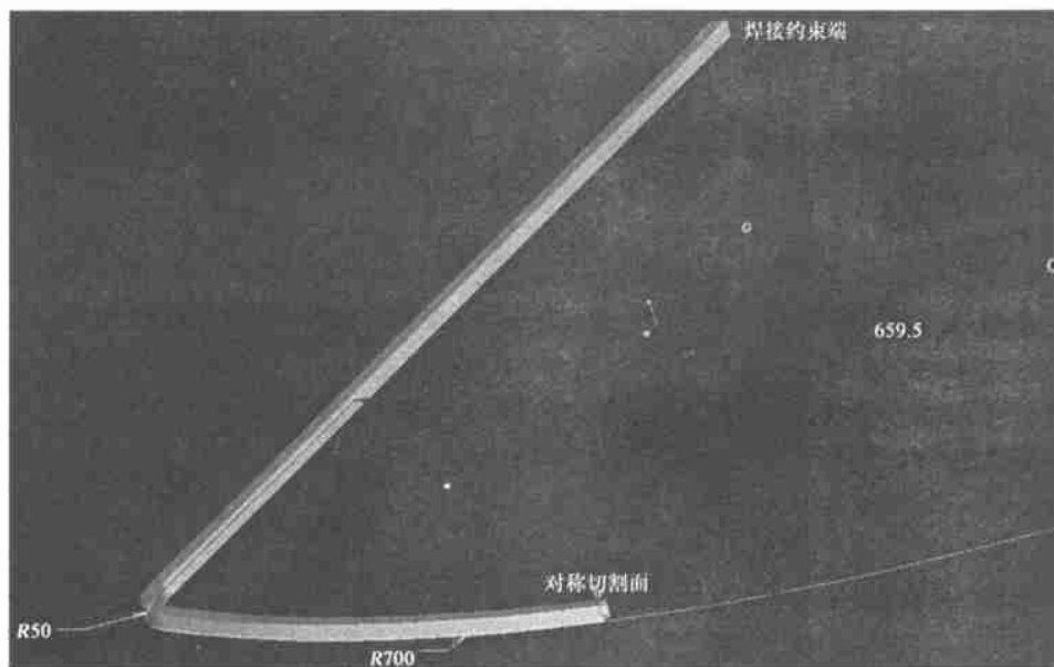
图 2 拱形气氮冷却屏的基元管道模型(已被对称切割)
